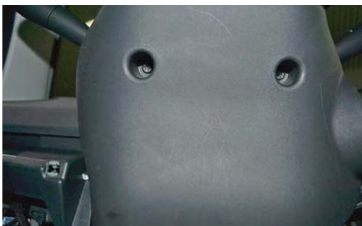
Фото. Саморезы крепления нижней части кожуха рулевого вала
