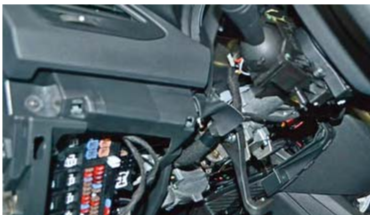
Фото. Саморезы крепления нижней части кожуха рулевого вала
