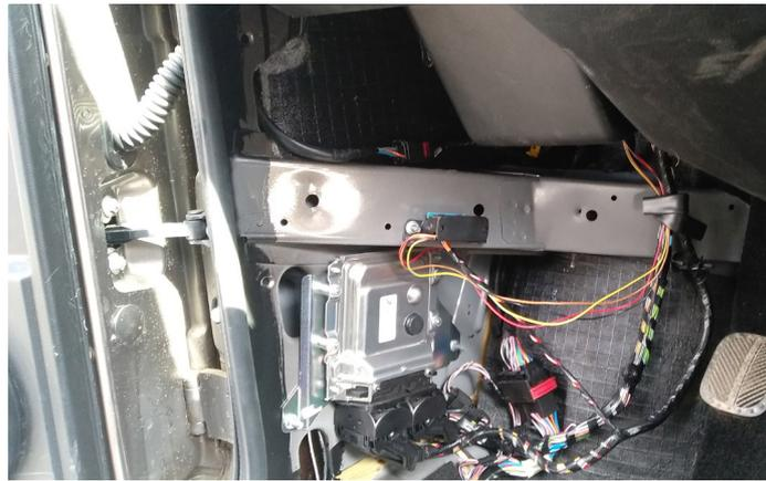
2. Открутите две гайки, которыми удерживается диагностическая колодка.
