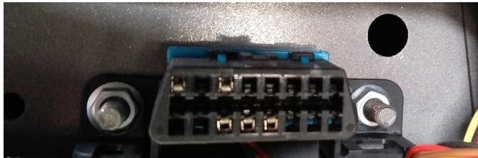
3. Соедините диагностические колодки БК и автомобиля.
