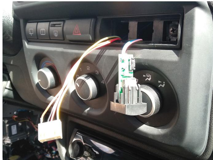
6. Подключите 6-контактную колодку жгута БК к бортовому компьютеру и установите его.
