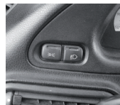
Рис. 7 Выключатель наружного освещения
