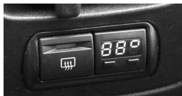
Рис.3 Вид установленного БК
