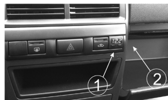
Рис.6 Вид установленного БК
