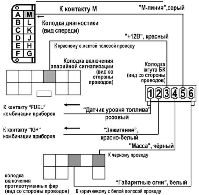
рис.16 Схема подключения к а/м Daewoo Nexia (до 2008 г.в.) (ЕВРО-2), ЗА3 Ланос Т150 (ЕВРО-2)
