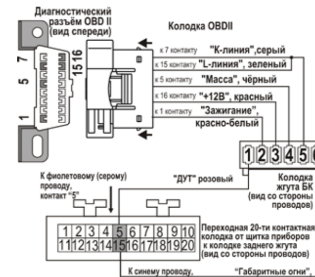
рис.13 Схема подключения к а/м Renault/Dacia Logan серии "Black Line"
